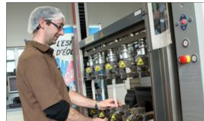
La résistance et l'élasticité des produits font l'objet de nombreux tests.
