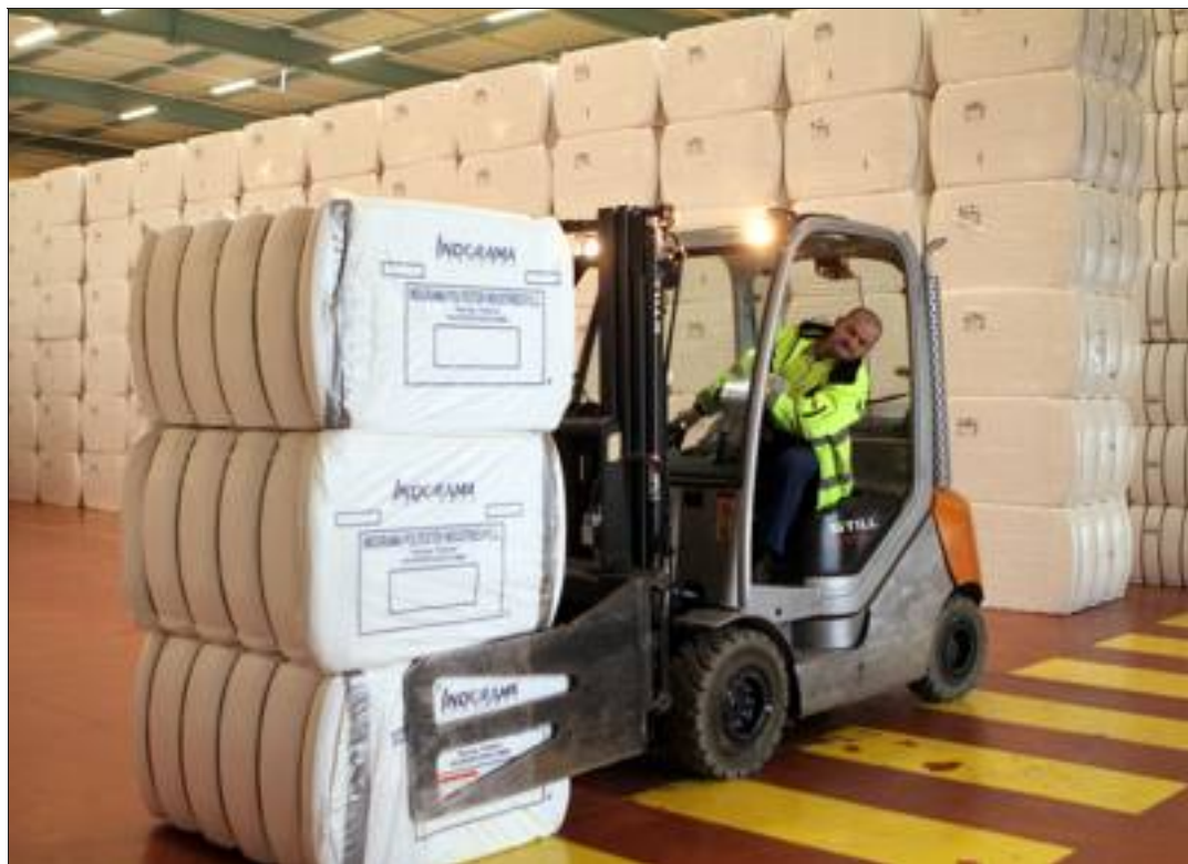
Les fibres arrivent compactées et sont dispersées dans des machines spéciales avant le cardage.
